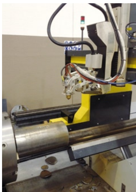
Testa bevel a 5 assi • 5 axis bevel head
